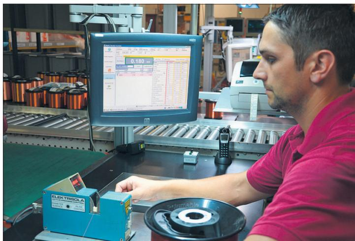
Markus Portmann macht die Ausgangsprüfung, bei der Durchmesser und Widerstand kontrolliert werden.
